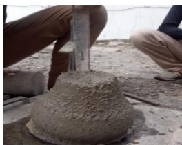
Gambar 4.9 Uji Slump V1
