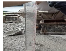
Gambar 4.11 Uji Slump V3
