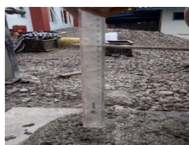
Gambar 4.10 Uji Slump V2
